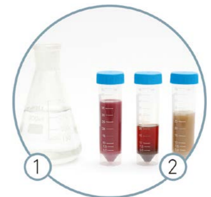
1 - Distillat pur 2 - Déchets concentrés
