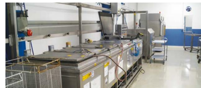
Im Lohnschichtungscenter werden Werkzeuge mit wenigen Millimetern bis hin zu 1,5 Meter behandelt, sowie z. B. Gussformen mit einem Gewicht von bis zu 5 Tonnen. Zudem können komplette Abschirmblechsätze in der Großteile-Entschichtung schonend entschichtet werden.
