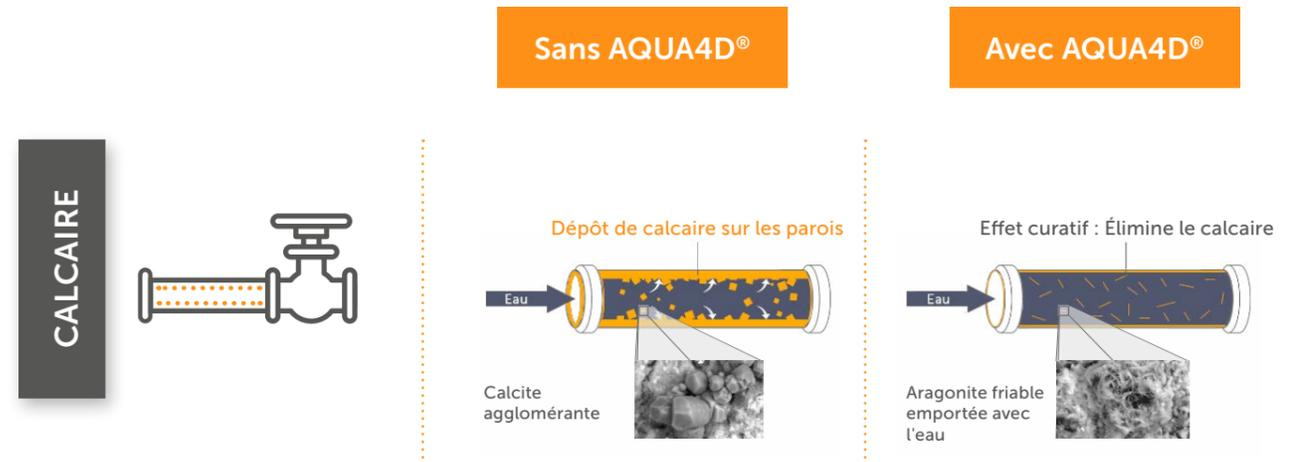
La technologie AQUA4D® agit sur la structure cristalline du calcaire  $\text{CaCO}_3$  passant à l'état friable et non agglomérant, l'aragonite. Le calcaire n'adhère donc plus aux surfaces.
