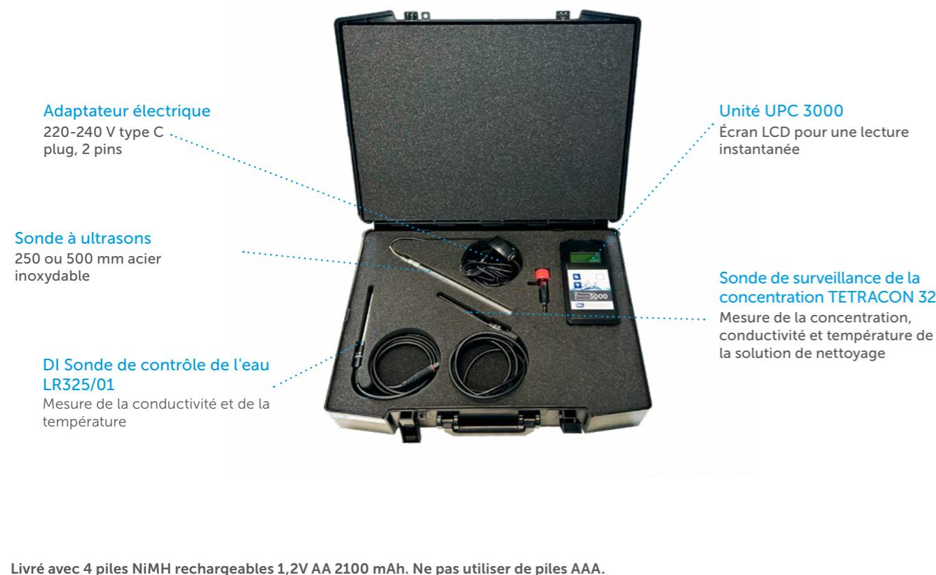
Livré avec 4 piles NiMH rechargeables 1,2V AA 2100 mAh. Ne pas utiliser de piles AAA.
