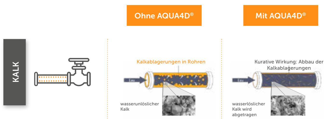
Die AQUA4D®-Technologie beeinflusst die kristalline Struktur des Kalks ( $\text{Ca}[\text{CO}_3]$ ), hin zu einer brüchigeren und nicht-agglomerierten Struktur, dem Aragonit, welches nicht an den Rohrwänden haftet.
