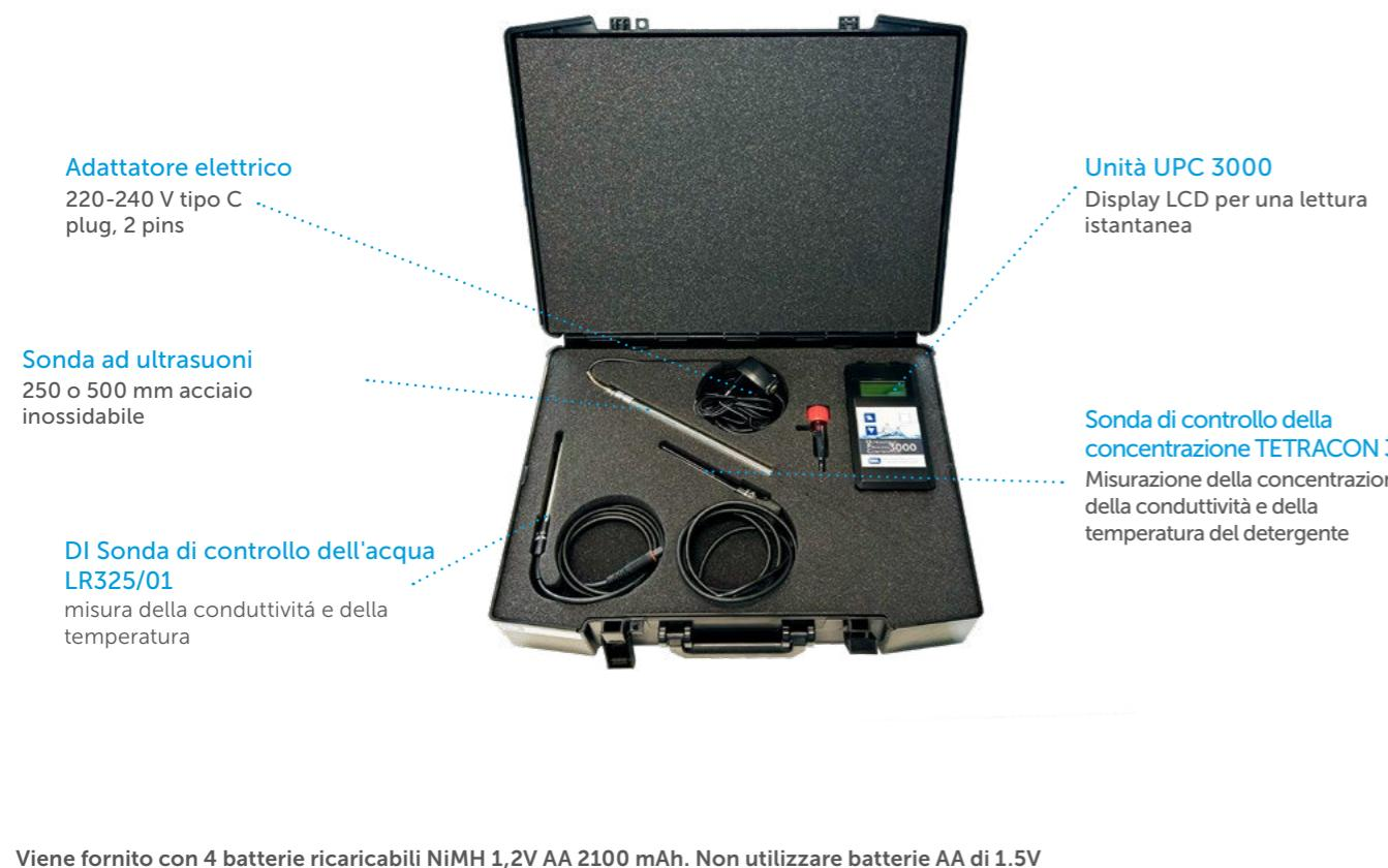
**! NON IMMERGERE LE SONDE NELL'ACQUA QUANDO IL DISPOSITIVO È COLLEGATO A UNA PRESA ELETTRICA!**
